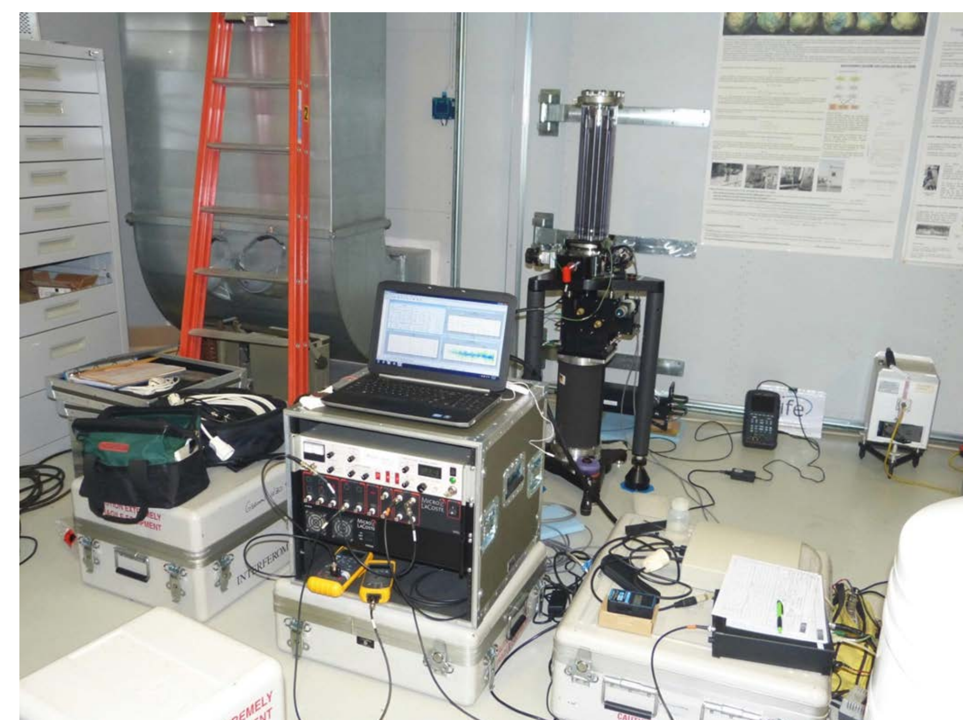
Absolute gravimeter FG5X-220 of IfE measuring at the Instituto Nazionale di Ricerca Metrologica (INRIM, Torino)
