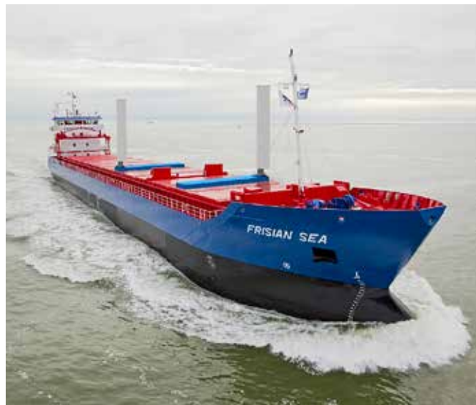
De Frisian Sea van Boomsma Shipping vaart met twee eConowind Ventifoils (foto Boomsma Shipping).
