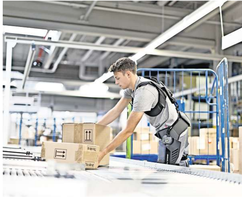
Exoskelette unterstützen Mitarbeiter bei körperlich schweren Tätigkeiten, wie hier in Logistik und Lagerhaltung.
